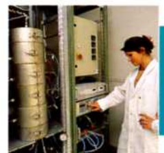
Unité test catalytique à l'échelle labo (ø 1")
