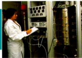
Unité de test catalytique, échelle labo (ø 1')
